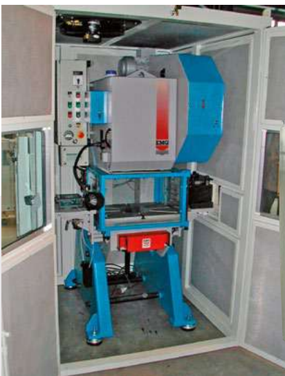
► PRENSA DE 25T con cabina insonorizada
