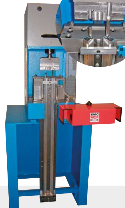
► 6TLP con utillaje de montaje de pasadores y modificación del bastidor
